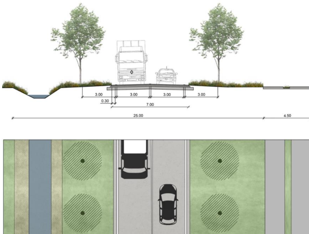
Figuur 41: Type dwarsprofiel voor een secundaire weg type II aan 70km/h met parallelle fiets- en landbouwweg
